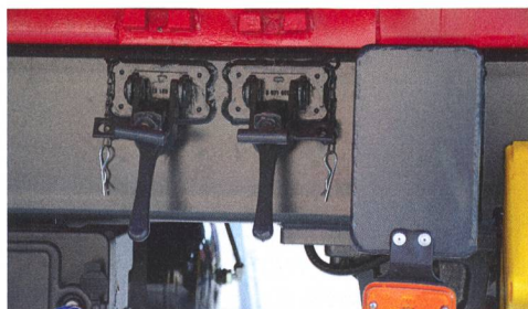
Des double raccords excentrés relient la machine montée avec le châssis de transport. Foto Hunger.
