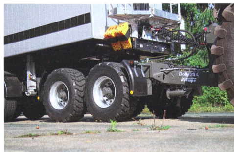
Une remorque Dolly transmet une charge considérable sur le tracteur, mais celui-ci ne devient pas un camion pour autant. (Foto Krampe)
