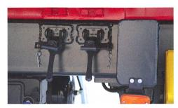
Des double raccords excentrés relient la machine montée avec le châssis de transport. Foto Hunger
