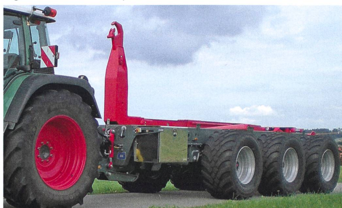
Le poids total élevé implique une monte pneumatique adaptée.
