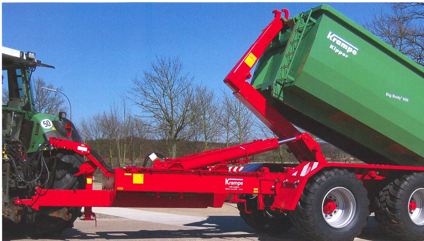
Un système de charge à crochet, un conteneur roulant et une paroi arrière actionnée hydrauliquement: tout cela pour une remorque basculante de haute valeur. Foto Krampe
