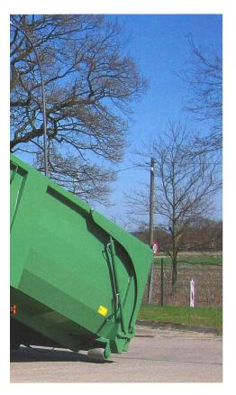
Fahr a mis au point en 1969 une nouvelle technique de transport avec le «FAHR-Container-System». Il s'agissait en l'occurrence d'un dispositif attelé à un tracteur et disposant d'un U ouvert à l'arrière, permettant de prendre en charge les conteneurs. Aujourd'hui encore, ce système de transport est utilisé dans le secteur communal et jardins et fabriqué par l'entreprise Gebr. Jäckle à Hilzingen/Schlatt (D).
