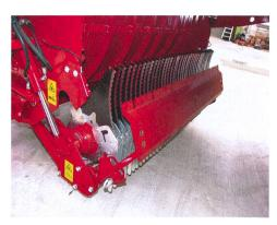
La barre de coupe est mise en place et retirée hydrauliquement.
