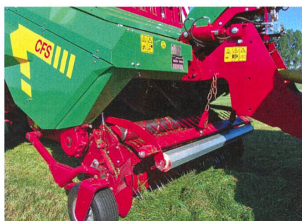
Aussi bien le pick-up que le rouleau accélérateur CFS exercent un effet de traction.
