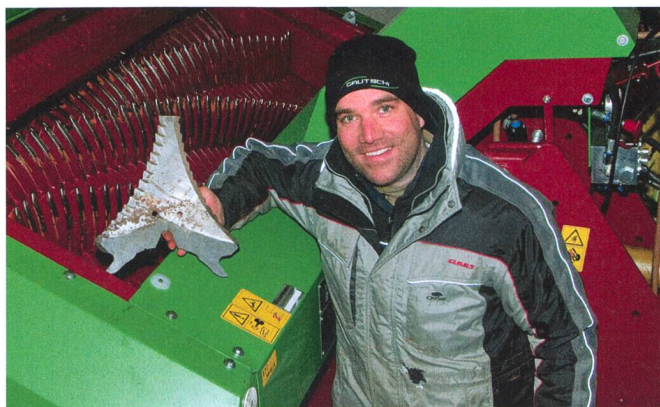
Reto Gautschi peut retourner les 45 couteaux doubles face de l'autochargeuse à coupe courte en l'espace de 10 à 15 minutes.
