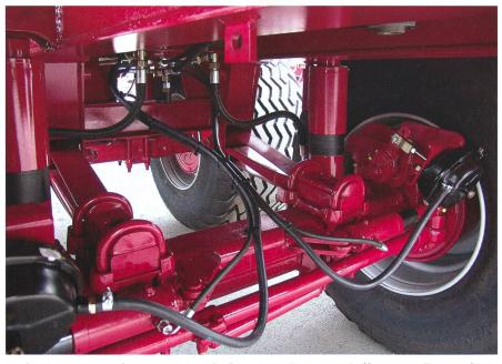
Le châssis est équipé d'une suspension hydropneumatique, ce qui offre un excellent confort et une bonne stabilité dans les pentes.
