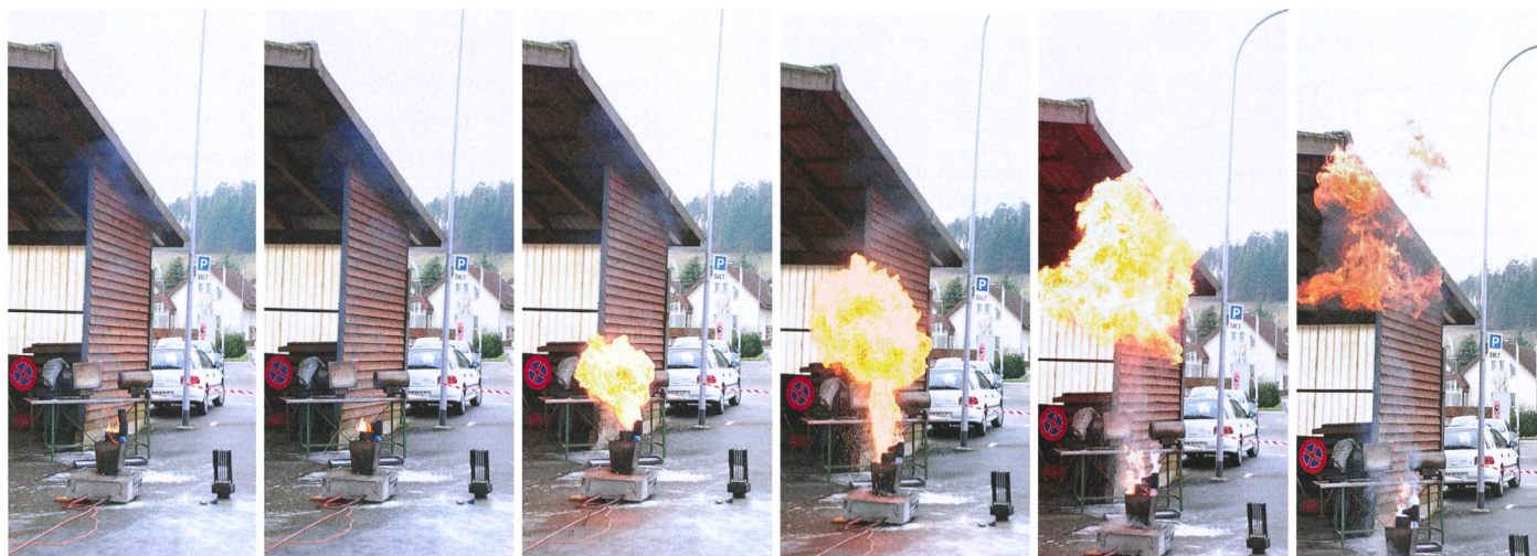
L'eau, dans un récipient, est versée sur la friteuse en feu et bascule, au moyen d'un palan à chaîne: la réaction est d'abord un gros vroom suivi d'un grésillement et d'un nuage de vapeur.
