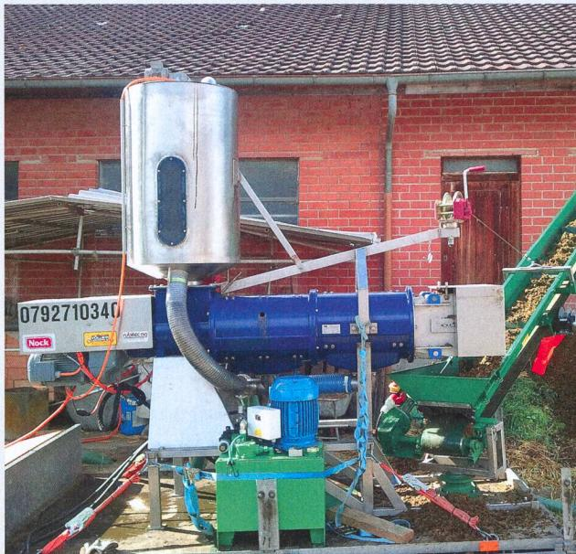
L'alimentation de cette installation à Bennwil (BL), chez Yves Leuenberger se fait par l'intermédiaire d'une turbopompe immergée (pompe centrifuge) avec dispositif de coupe et entraînement hydraulique. Un élément hydraulique à entraînement électrique génère le flux d'huile. Un répartiteur de débit permet de réguler l'alimentation en fonction des besoins du séparateur. Un réservoir tampon
