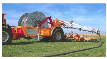
L'« Enrouleur de tuyau Rotomax » de Veenhuis permet, grâce à un long bras, d'utiliser un injecteur à disques alimenté par tuyau. Cela pourrait constituer une solution pour les automotrices également.
