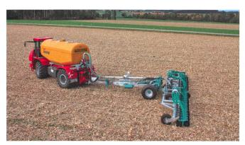
Avec cette nouveauté, l'injecteur à disques attelé «Zunidrill Mobil», Zunhammer est parvenu à réduire sensiblement le poids de l'essieu arrière de l'automotrice. (Photo d'usine)
