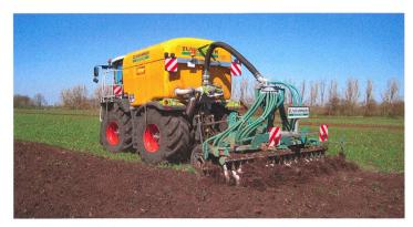
Les herses à disques compactes exigent une vitesse de travail de 12 à 15 km/h et, par conséquent, une puissance élevée. (Photo d'usine)
