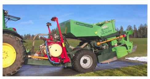
Le cylindre de traction hydraulique reprend en majeure partie la force d'appui négative. Le dispositif de traitement est visible à l'avant de la machine. Le remplissage se fait en général avec un palettiseur arrière, au frontal ou au moyen d'un chargeur télescopique. La trémie offre une capacité atteignant jusqu'à trois tonnes de plants de pommes de terre.
