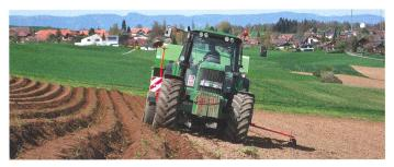
Les pommes de terre sont toujours placées au centre du sillon, cela même dans les pentes. La profondeur de plantation est exacte et régulière grâce à l'effet de jauge des roues généreuses de la machine.
