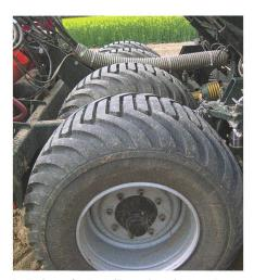
Le train roulant surdimensionné permet une grande régularité de la profondeur de la machine, ainsi qu'une première préparation de la surface du terrain.
