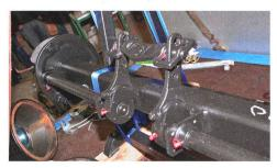
Généralement, les essieux de bonne facture disposent de freins intégrés avec lubrification des parties mobiles.
