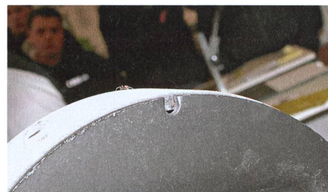
La puissance des mâchoires de freins se voit du premier coup d'œil au travers d'une encoche.
