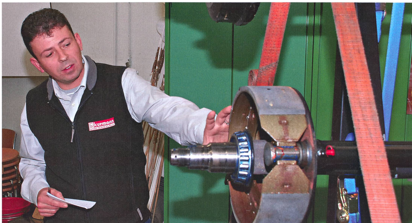
Recommandation de Urs Kurmann : des freins généreusement dimensionnés réduisent l'usure et évite les dégâts. (Photos : Dominik Senn)
