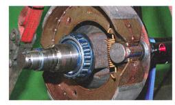
Intérieur de l'essieu et dispositif de transfert par arbre aux mâchoires de frein d'un essieu simple jusqu'à 8 t avec 6 boulons ...
