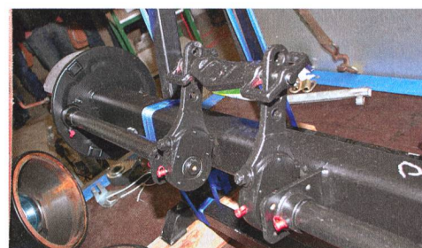
Généralement, les essieux de bonne facture disposent de freins intégrés avec lubrification des parties mobiles.
