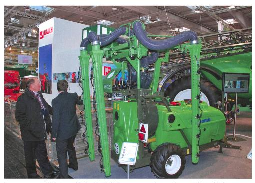
Les nouveaux pulvérisateurs viticoles Vectis de Tecnoma, avec timon suiveur, est disponible à choix avec un réservoir de 800 I, 1000 I ou 1200 I. Le souffleur déclenchable et les rampes sont disposés derrière le réservoir. Les éléments de pulvérisation servent au traitement de part et d'autre des rangs. La hauteur et l'inclinaison des supports de buses sont réglables. Il est possible de traiter à la fois deux ou trois rangs.
