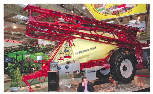
Les appareils Commander de Hardi possèdent deux souffleurs axiaux: des sacs d'air veillent à une répartition équilibrée de l'air sur toute la largeur de la rampe. L'air accélère les gouttes de produit et permet des vitesses de traitement plus élevées. Le réglage de l'angle des buses et du volume d'air constitue une particularité de la technique Hardi.
