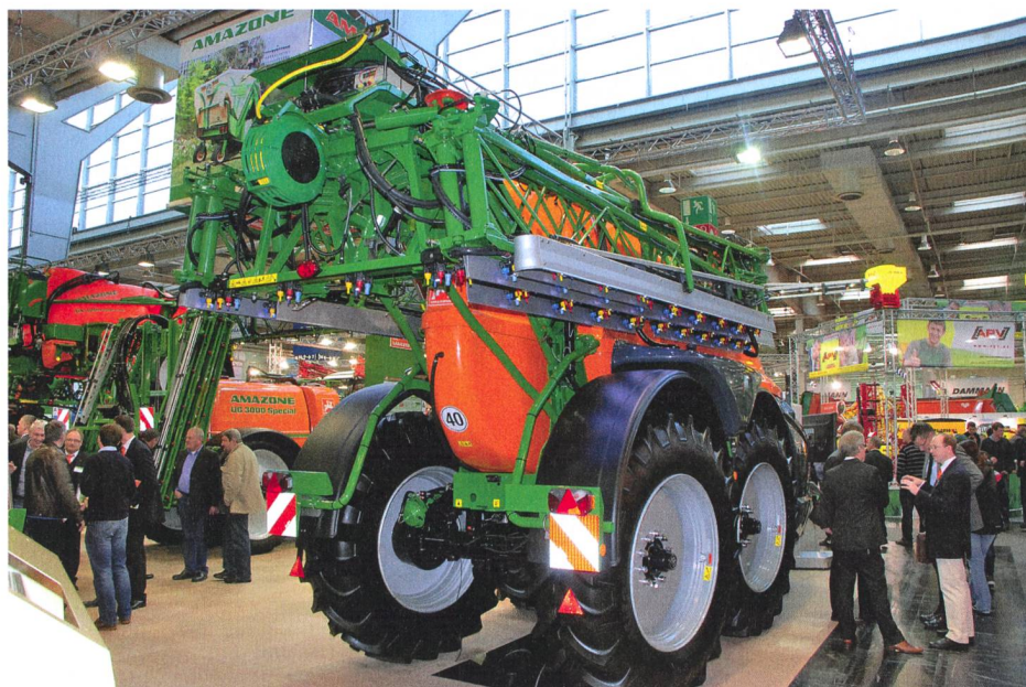
Avec la 200-PS-Pantera 4001 (8,40 m de long, 3,80 m de haut et 2,75 m de large), Amazone complète vers le haut son programme de machines de traitement phytosanitaire. Un levier multifonction, avec commandes du véhicule et du pulvérisateur intégrées, sert de levier de conduite. Le régime de la pompe de pulvérisation est réglable en continu.
