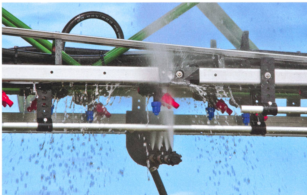
Les buses à haute pression se déplacent le long des rampes et nettoient plus précisément que les nettoyages manuels. Avec le système BoomWash d'Amazone, l'utilisateur voit sa tâche largement facilitée par le nettoyage des rampes au champ. Le déversement dans l'environnement par le rinçage des rampes dans des zones sensibles ou à la ferme est ainsi évité.
