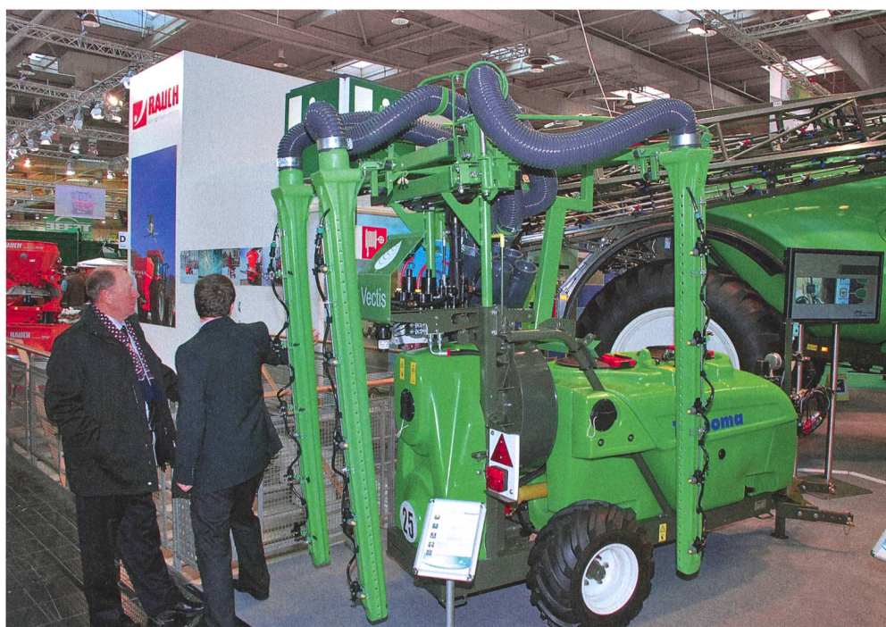
Les nouveaux pulvérisateurs viticoles Vectis de Tecnomat, avec timon suiveur, est disponible à choix avec un réservoir de 800 l, 1000 l ou 1200 l. Le souffleur déclenchable et les rampes sont disposés derrière le réservoir. Les éléments de pulvérisation servent au traitement de part et d'autre des rangs. La hauteur et l'inclinaison des supports de buses sont réglables. Il est possible de traiter à la fois deux ou trois rangs.
