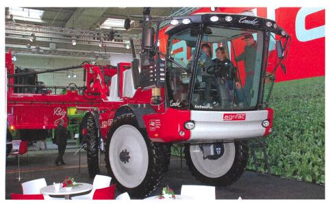
Le Condor d'Agrifac possède un châssis avec suspension pneumatique, un réglage en continu de la voie de 150 à 225 cm (300 cm en option), une garde au sol de 125 cm (200 cm en option), une largeur de travail jusqu'à 51 m, un réservoir atteignant 5000 l et pratiquement tous les dispositifs d'assistance électronique. Les rampes d'épandage sont réglables en hauteur de 50 à 325 cm.
