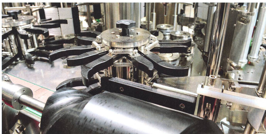
L'étoile universelle développée par GAI permet de travailler des bouteilles d'un diamètre de 60 à 115 mm. Les deux pinces de prise sont indépendantes entre elles, permettant le travail avec des bouteilles coniques. (Photo d'usine)
