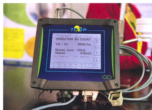
La société Tixad, basée à Montpellier, propose un dispositif électronique pour la maîtrise de l'application et de la traçabilité des produits de protection des plantes.
