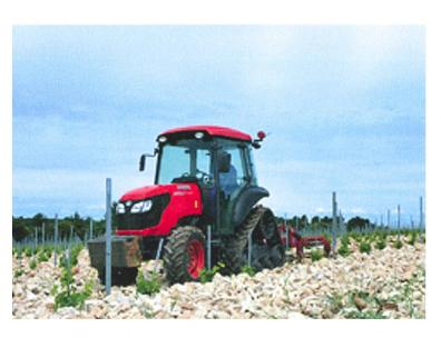
Kubota a présenté au SITEVI son tracteur spécialisé M8540 DTNQ. Ce tracteur est muni d'un jeu de chenilles uniquement sur l'essieu arrière et d'une largeur de 30 cm seulement. Malgré l'étroitesse des chenilles, la surface au sol est presque quadruplée, réduisant d'autant la pression exercée sur le sol. Ce train de chenille offre également une meilleure traction et une moindre sensibilité au ripage dans les dévers. Il est homologué sur route et peut rouler à 25 km/heure.
