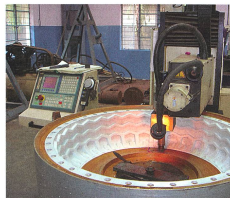
«Moule de cuisson» pour pneu. Selon les dimensions, la vulcanisation dure de 30 à 150 minutes.
