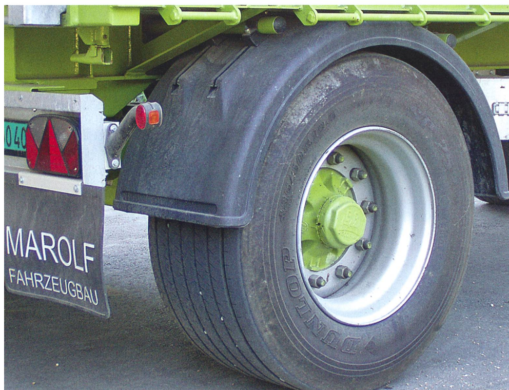
Ces pneus de route demandent une pression de gonflage élevée et procurent ainsi une faible résistance au roulement. (Photos Ruedi Hunger)
