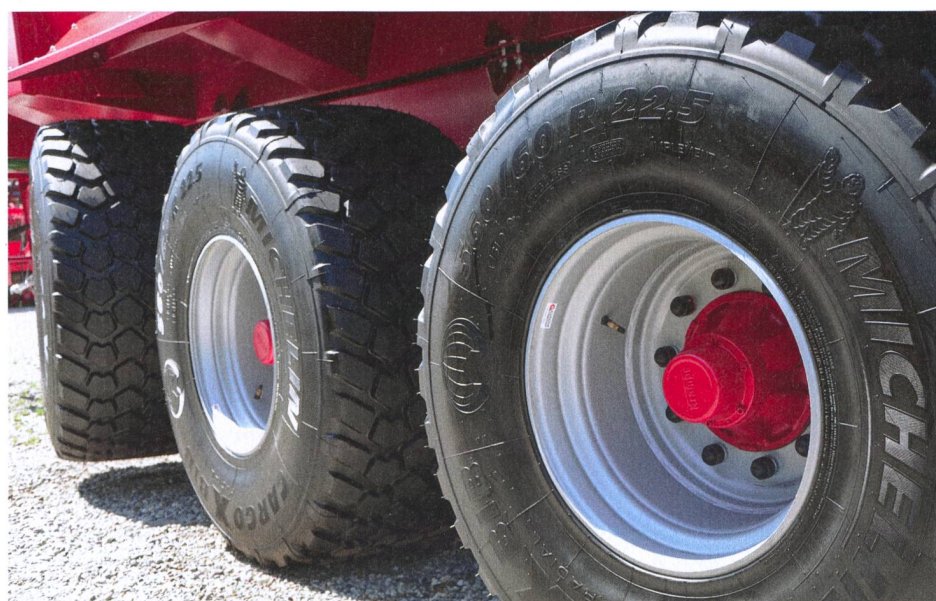
Pneus Twin Radial: la hauteur des barrettes est la cause directe des bruits de roulement sur route.
