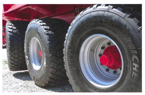
Pneus Twin Radial: la hauteur des barrettes est la cause directe des bruits de roulement sur
