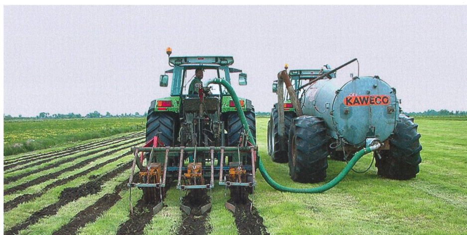
En Hollande, l'épandage de lisier localisé est aussi réalisé avec le semis sur bandes fraîsées.
