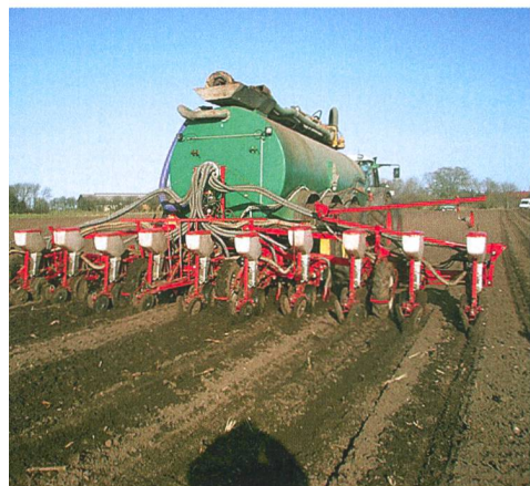
Ce tonneau à pression tridem utilisé au Danemark réalise l'épandage de lisier localisé et le semis de maïs sur douze lignes en un seul passage. (Source : www.langelundaps.dk )
