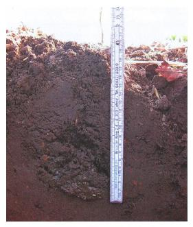
L'injecteur de lisier Xtill S de Vogelsang dépose une bande de lisier à 10-20 cm de profondeur. (Photo: màd)
