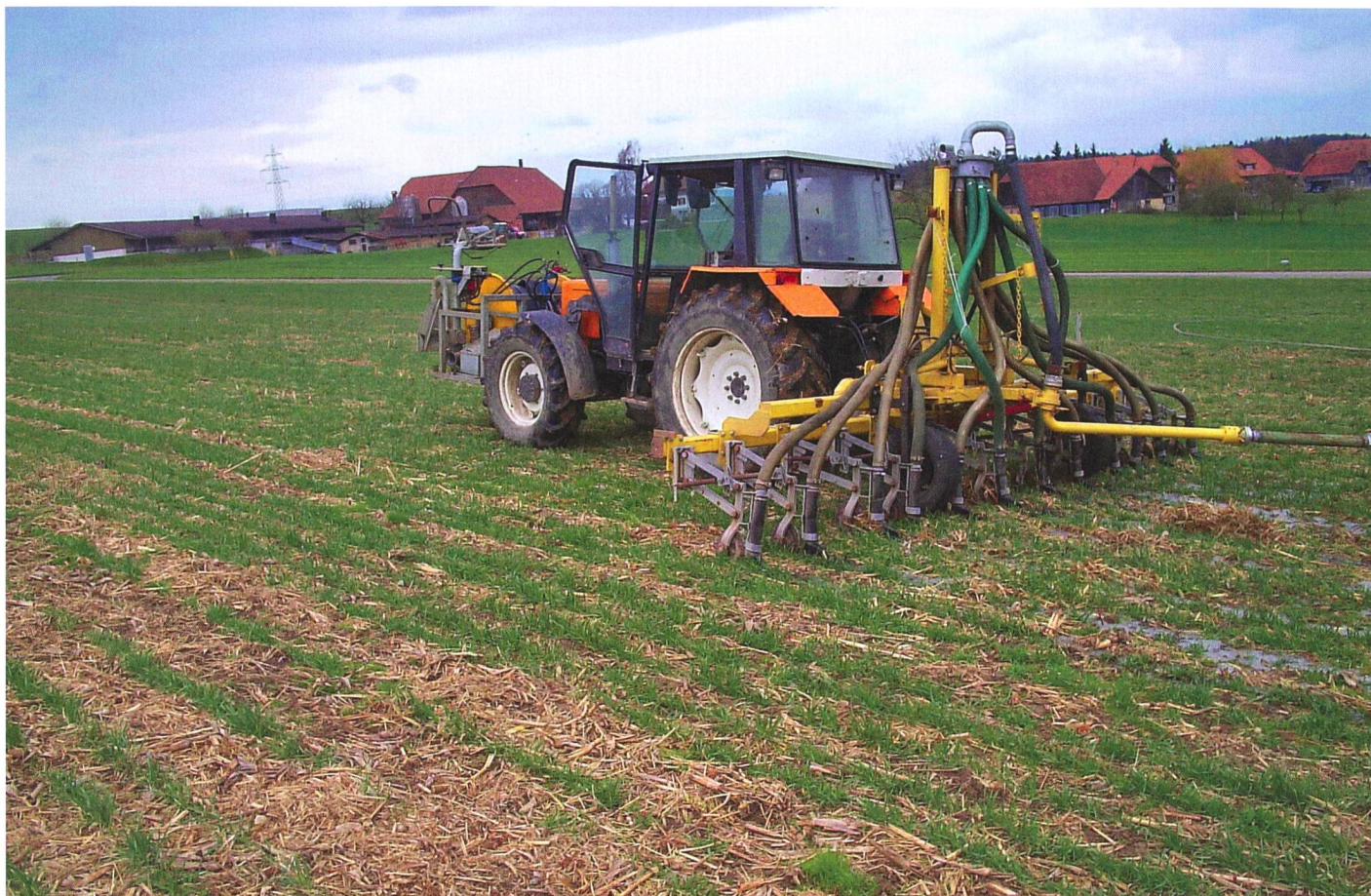
L'injecteur de lisier de Martin Häberli est équipé de disques de Veenhuis. (Photo: M. Häberli)
