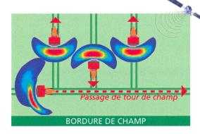
Illustration du système Stop&Go des épandeurs d'engrais SulKy de la série X12-44, exemple de la grande variété de dispositifs automatiques pour l'épandage en bord de champ.
