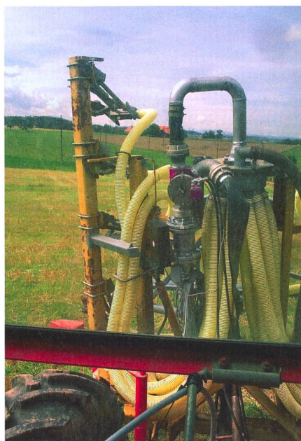
Pour contrôler le volume de lisier épandu, un débitmètre est recommandé.
