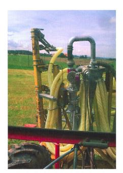
Pour contrôler le volume de lisier épandu, un débitmètre est recommandé.
