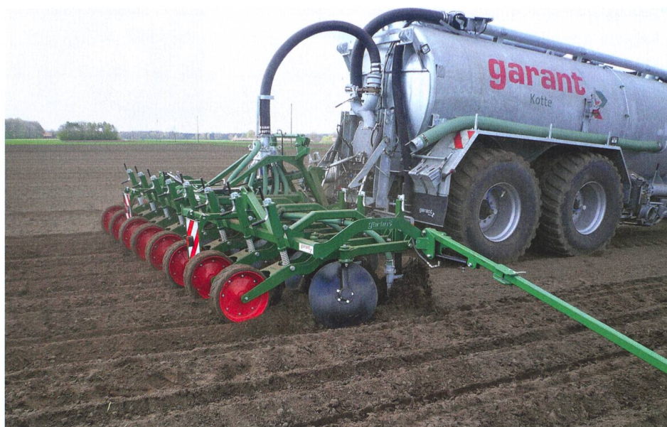
Le PreMaister de Kotte a été développé pour l'épandage de lisier localisé.
