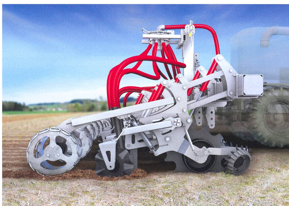
La machine de travail du sol XTill S de Vogelsang nettoie et travaille des bandes de 25 cm de large. (Photo: mäd)
