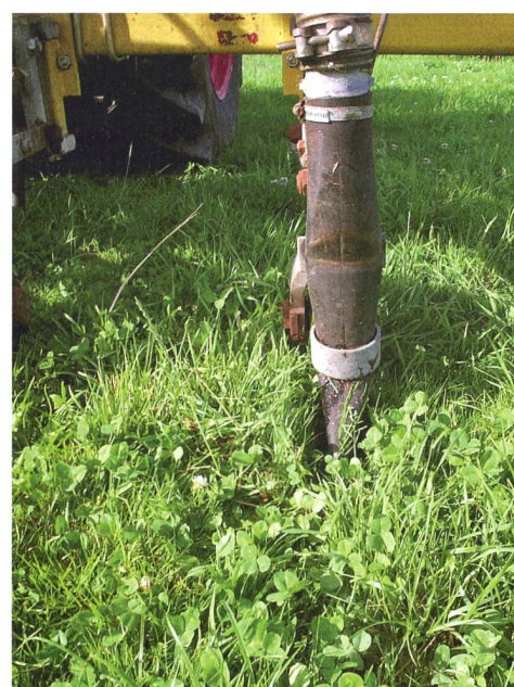
Martin Häberli utilise son injecteur à disques avec une distance interligne de 50 cm dans les prairies également. (Photo : M. Häberli)
