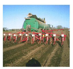
Ce tonneau à pression tridem utilisé au Danemark réalise l'épandage de lisier localisé et le semis de maïs sur douze lignes en un seul passage. (Source: www.langelundaps.dk)
