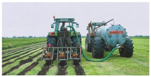
En Hollande, l'épandage de lisier localisé est aussi réalisé avec le semis sur bandes fraisées. (Photo: Thomas Anken)
