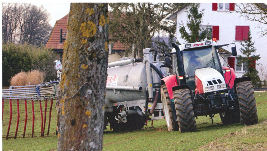
Pour les exploitations suisses de taille moyenne, le tonneau à pression utilisé en commun s'avère une solution rentable. Combinée avec le répartiteur à tuyaux souples, les fenêtres d'utilisation sont plus larges, ce qui permet d'éviter les conflits en matière de disponibilité des machines. (Photos : Ueli Zweifel)
