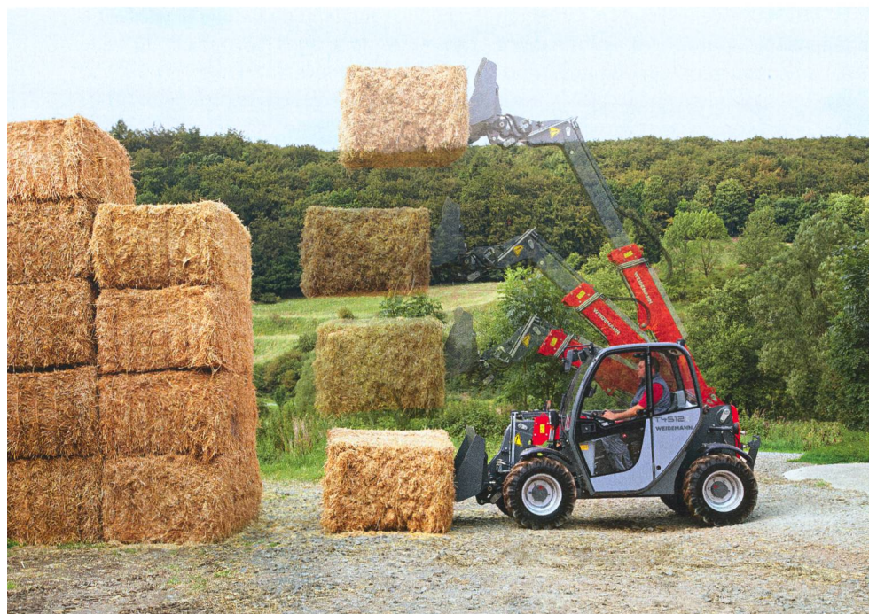
Le nouveau Vertikal Lift System (VLS) de Weidemann apporte un avantage décisif pour la stabilité de la machine: il maintient en permanence le bras télescopique dans une position aussi proche que possible de la verticale.
