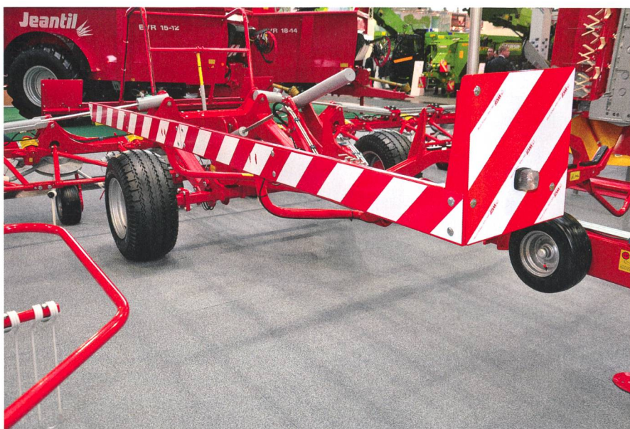
Certaines nouvelles pirouettes trainées, ici un modèle SIP, sont équipées d'une protection latérale qui recouvre en grande partie les points saillants.
