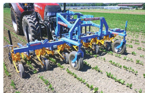
La sarcluse à socs de Schmotzer existe pour un montage frontal. (Représenté par GVS-Fried AG, Koblenz). (Photo : Hansueli Dierauer)
