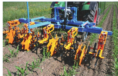
La sarcluse de Schmotzer dispose de socs «patte d'oeil» sur parallélogramme. (Représenté par GVS-Fried AG, Koblenz). (Photo SP)
