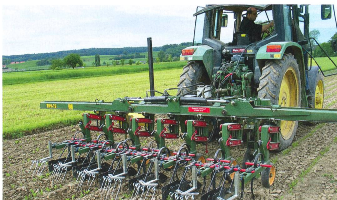
La sarcleuse à socs de Thyregod avec caméra de surveillance. (Représenté par Daniel Wyss, Landtechnik, Ruppoldsriet).
