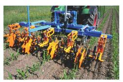
La sarcleuse de Schmotzer dispose de socs «patte d'oie» sur parallélogramme. (Représenté par GVS-Fried AG, Koblenz). (Photo SP)
