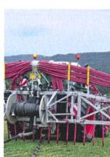
**Epanleur à pendillards et à tuyaux souples contre les pertes d'azote et le tassement du sol. (Photo: Ueli Zweifel)**
