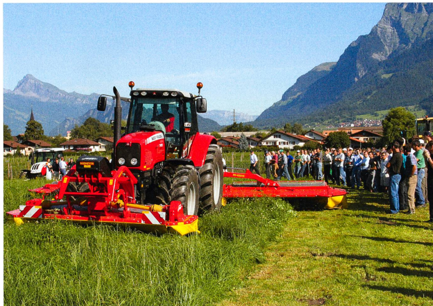
La faucheuse frontale, en version tractée suspendue, convient bien en combinaison avec les deux faucheuses arrière.
