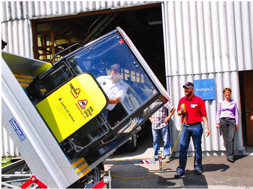
Natanael Burgherr fait basculer la cabine jusqu'à 60°; heureusement que le «conducteur» est attaché!
