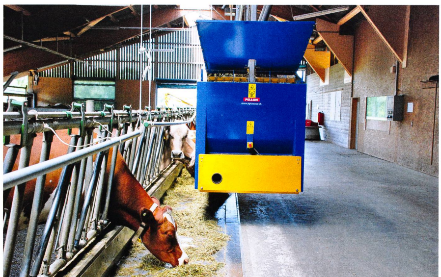
Le robot-distributeur de fourrage de la station de recherche ART comme on le rencontre souvent dans les pays nordiques.
