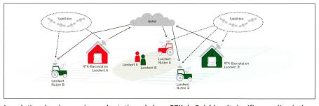
La solution de mise en réseau de stations de base RTK de Reichhardt signifie pour l'agriculteur, et pour la première fois, la possibilité d'introduire sur son exploitation tous les avantages d'un système de guidage automatique de haute précision incluant l'adaptation de la largeur et la gestion des données. (Graphique: Reichhardt)
