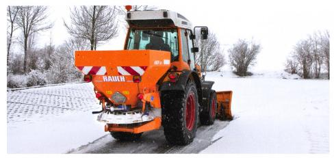
Rauch présente pour la première fois une régulation de la largeur d'épandage commandée à distance pour son distributeur hivernal Axeo 6.1. Ce système adapte le volume selon que ce soit du sable, du sel, du gravier ou de l'engrais. L'électronique intelligente considère même les réglages des côtés gauche et droit.
