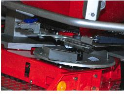
La commande Spread Control de Rauch pour épandeur à disques offre la possibilité d'ouvrir et de fermer automatiquement le doseur en bout de champs et dans les parcelles irrégulières, cela tout en prenant en compte les caractéristiques de l'engrais minéral.
