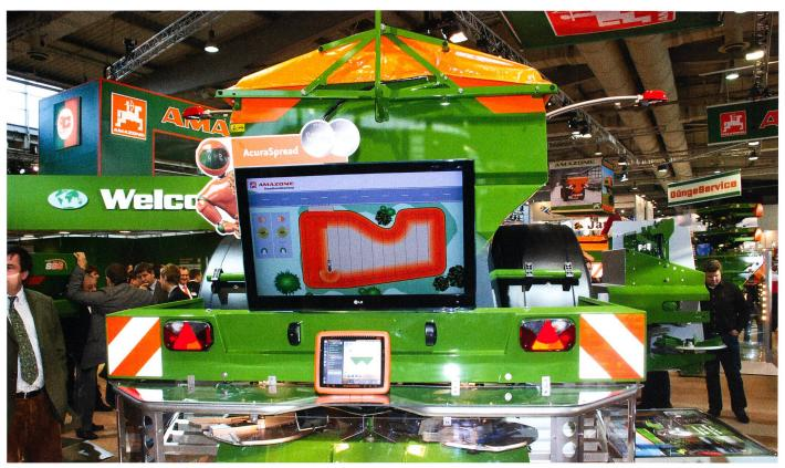
L'AcuraSpread d'Amazone est un logiciel intelligent pour l'utilisation des soldes de traitement. Il adapte le débit d'épandage en fonction de la quantité restante dans le réservoir et de la surface à traiter.
