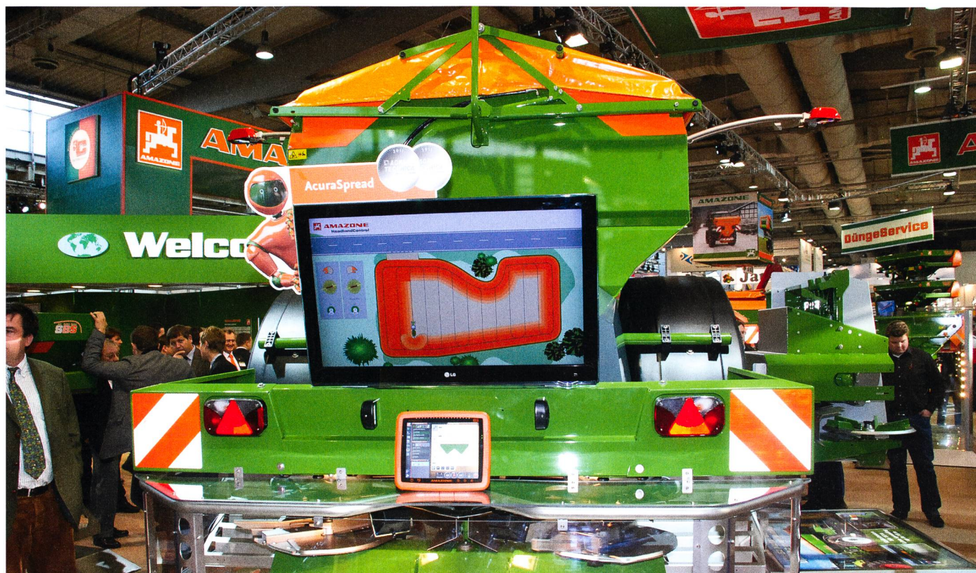
L'AcuraSpread d'Amazone est un logiciel intelligent pour l'utilisation des soldes de traitement. Il adapte le débit d'épandage en fonction de la quantité restante dans le réservoir et de la surface à traiter.
