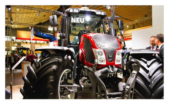
Le nouveau Valtra N163 avec technique SCR et filtre à particules. C'est le tracteur 4 cylindres le plus puissant du monde avec 163 Ch (171 Ch avec Powerboost). Dans les derniers modèles, le nouveau mode de construction a permis d'améliorer l'angle de braquage des roues.
