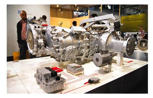
ZF propose le module de générateur ZF-Terra+ construit selon un principe modulaire pouvant être soit intégré à la transmission, soit monté séparément comme module de prise de force avec système électronique et gestion énergétique compris. Le nouvel essieu articulé ZF-Terrasteer complète la chaîne cinématique en un système global proche de la perfection.
