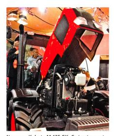
Nouveau Kubota M 135 GX. Ce tracteur est encore un prototype qui devrait se produire en série à fin 2012. Sa puissance (97/68EG) correspond à quelque 100 kW/136 Ch avec technique SCR. Ce tracteur dispose d'un entraînement à passage sous charge 8 paliers et fonction automatique.
