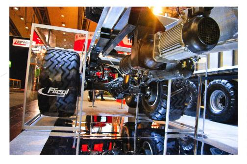
Essieu moteur « Power Drive Elect », fruit de la collaboration avec John Deere. Ce système utilise l'efficacité énergétique de générateurs électriques intégrés des tracteurs de nouvelle génération. Grâce à l'essieu moteur, le tracteur devra certes disposer de la puissance nécessaire, mais sa construction pourra être plus légère qu'aujourd'hui.
