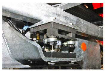
Technique de pesage Fliegl avec capteurs de pression et d'extension: les capteurs actuels avec box de répartition sont remplacés par des cellules de pesage électroniques digitales spéciales. Elles disposent d'une sortie Can-Bus directe permettant la saisie, l'enregistrement et la traçabilité dans le terminal Isobus.
