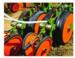
Des constructeurs réputés de technique de semis utilisent aujourd'hui l'air comprimé pour l'amenée de la semence.
