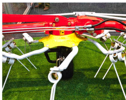
Pöttinger donne une nouvelle forme au bras porte-dents et assure ainsi une meilleure efficacité lors du fanage.
