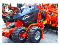
En plus des deux roues de grand volume à basse pression, quatre roues antérieures supportent maintenant le poids de la machine.
