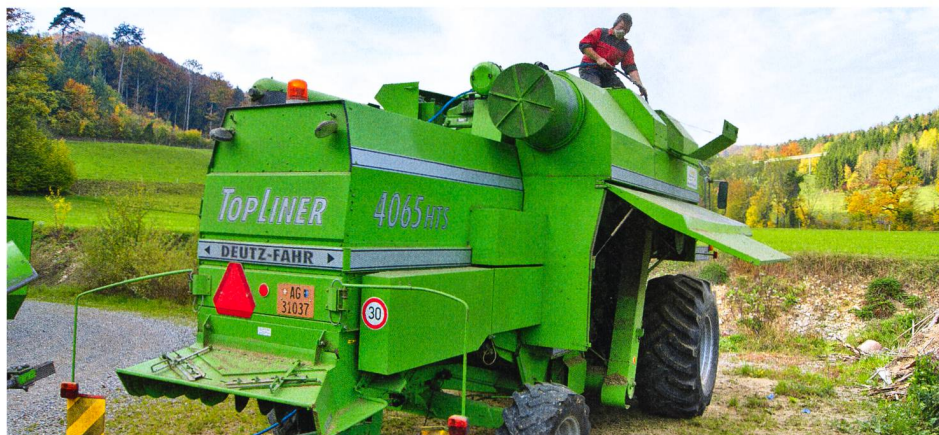
Le nettoyage de la moissonneuse-batteuse se fait à l'air, sans eau; on prolonge ainsi la durée de vie de la machine.
