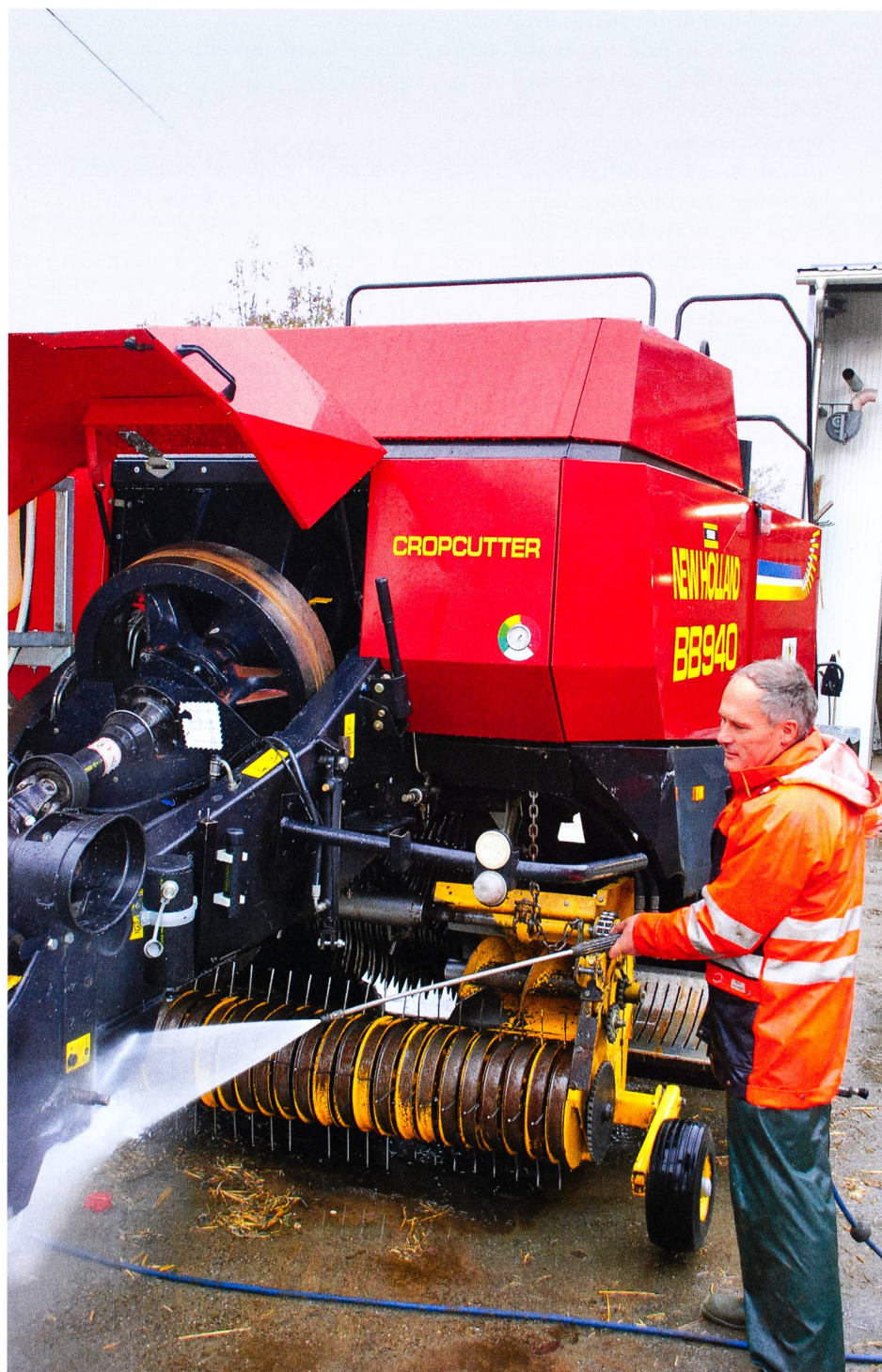
Ruedi Emch effectue un lavage   haute pression pour pouvoir d tecter d' ventuels d g ts cach s que seul un examen minutieux peut r v ler. (Photos : Hansueli Schmid, Dominik Senn)
