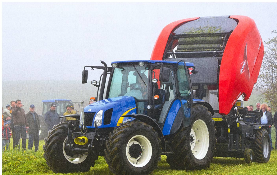
Un succès sur le marché des tracteurs suisses: la série T5 de New Holland. Ici, un tracteur de la gamme attelé d'une KUHN- i-BIO. Cette machine produit des balles rondes d'un diamètre fixe de 125 cm. Elle atteint un haut niveau de performance grâce à son double rotor d'alimentation, son plancher inclinable hydrauliquement et son dispositif d'enrubannage intégré.
