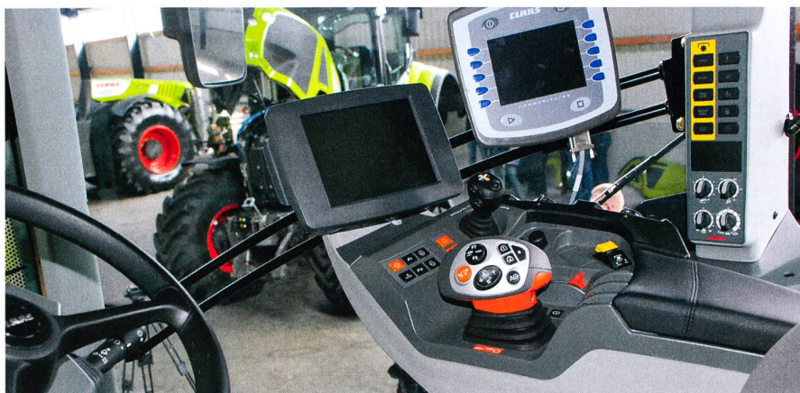
Dans le cockpit à droite du volant: le tableau de commande A (Cmotion et terminal Cebis) et le tableau de commande B (commandes Isobus et GPS).
