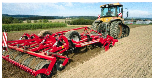
Le Terrano 4 MT est surtout destiné aux sols lourds. Il les décompacte en profondeur, tout en réalisant un enfouissement superficiel des restes de récolte.
