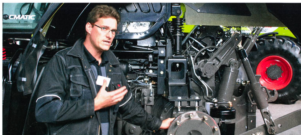
Ansgar Koenen explique la construction et le fonctionnement de l'essieu arrière. Au centre de la photo, l'un des quatre éléments de suspension de la cabine.
