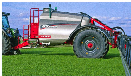
Le pulvérisateur Leeb GS 8000 est le troisième de la gamme. Ce modèle tracté 8000 l est une évolution du Leeb GS 6000, plus petit.
