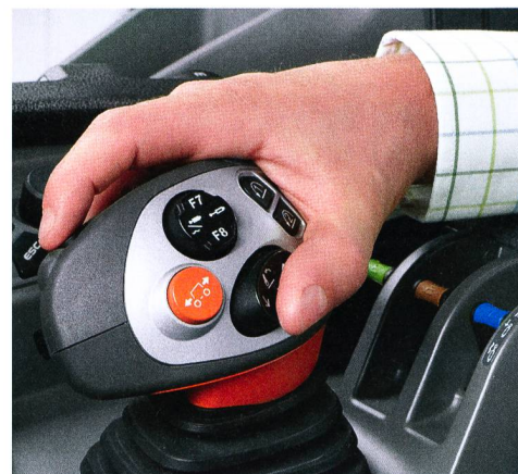
Le nouveau concept à trois doigts permet la commande intuitive d'une vingtaine de fonctions différentes, sans devoir changer sa main de place. (Photo d'usine)
