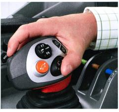
Le nouveau concept à trois doigts permet la commande intuitive d'une vingtaine de fonctions différentes, sans devoir changer sa main de place. (Photo d'usine)
