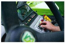
Le bouton de commande rotatif à droite permet de modifier le régime du moteur et de la prise de force, quelle que soit la vitesse du véhicule.
