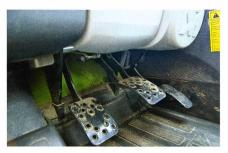
Avec la pédale Inch, la vitesse se régule sans incidence sur le débit du système hydraulique, ni sur le régime de la prise de force.
