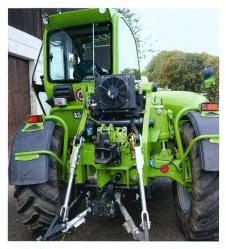
Le Mulitfarmer peut assumer une charge remorquable de 21 tonnes. L'hydraulique arrière, fixée directement au châssis, se déplace également lors de la compensation d'un dénivelé latéral grâce aux cylindres hydrauliques.
