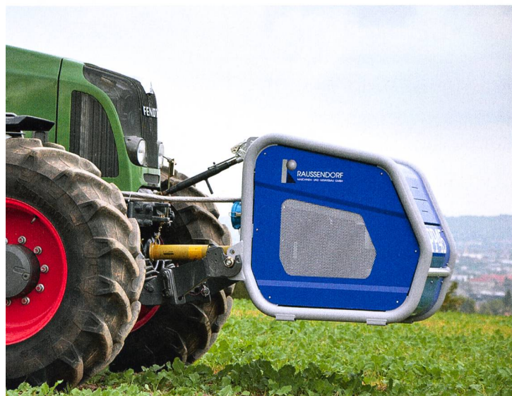
Le PowerPack 45 de la firme Raussendorf produit jusqu'à 45 kW de puissance électrique pour des outils portés, sans que des transformations du tracteur ne soient nécessaires. Photo : EAAT Chemnitz
