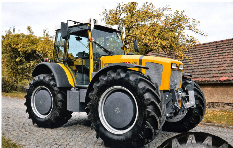
Ce Rigitrac SK 120 est équipé de quatre moteurs entraînant les moyeux des roues. Il sera exposé à l'Agritechnica.
