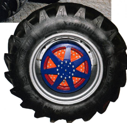
Entraînement électrique par le moyeu développé par l'Université technique de Dresde. La partie de couleur orange est le statif fixé sur l'essieu avec la transmission planétaire autour de laquelle tourne le rotor (bleu) avec la roue. Photo: Carmen Rudolph
