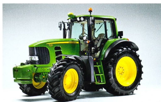
Les tracteurs E-Premium de John Deere font partie des premiers modèles de série comprenant un système intégré qui produit et distribue une puissance électrique élevée.
