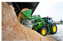
La nouvelle génération de chargeurs frontaux propose des positions programmables des bras oscillants et des outils du chargeur, ainsi qu'un retour en position électronique automatique – sur toute la course de relevage – des outils du chargeur (guidage tangentiel électro-hydraulique). Le tracteur et le chargeur frontal forment une unité fonctionnelle grâce au réglage depuis la console du tracteur.
