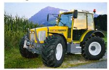
Les moteurs électriques de chaque roue peuvent être commandés de façon individuelle et très précise, ce qui permet, pour la première fois, d'obtenir des couples précis autour de l'axe élevé (torque vectoring). Le travail en pente devient ainsi plus sûr, et c'est la condition préalable à l'optimisation de la traction en plaine. Une puissance électrique pouvant atteindre 80 kW peut être livrée à un consommateur externe.
