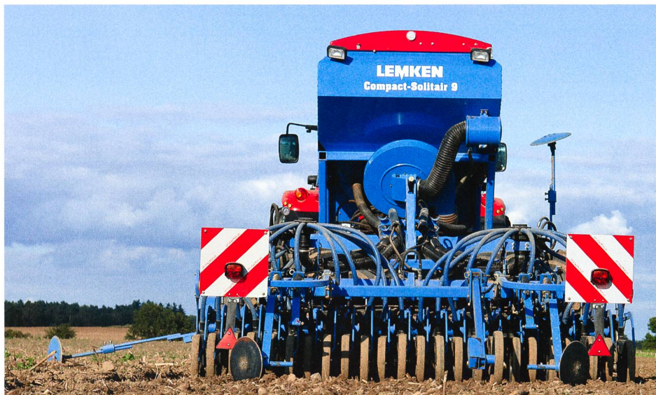
Les combinaisons de semis deviennent de plus en plus performantes. La combinaison Compact-Solitaire de Lemken comprend un conteneur de semences de 3500 l.
