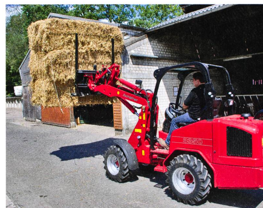
Les chargeurs de ferme sont des auxiliaires appréciés. A ne pas oublier : la visibilité aux commandes est limitée et le risque de renversement élevé.
