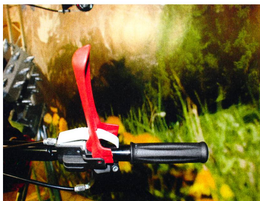
En libérant le levier « homme mort », le moteur des faucheuses monoaxe, des fraiseuses et des hacheuses ne s'arrête plus: seuls les outils et l'entraînement sont neutralisés.
