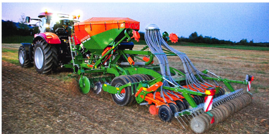
En action au crépuscule, le semoir Cirrus 3002 Amazone avec réservoir/doseur, herse à disques compacte pour la préparation du lit de semences, rouleau à pneus trapézoïdaux pour le raffermissement du sol, dépose de la semence et recouvrement avec herse et rouleau.
