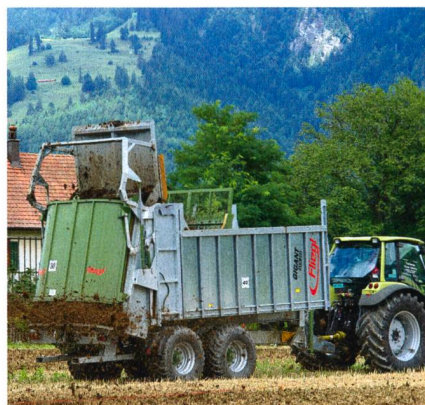
Les bennes galvanisées de l'épandeur à fumier, avec paroi mobile équipée de deux rouleaux d'épandage verticaux, absorbe entre 9 et 14 m 3 .
