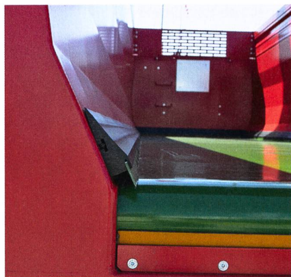
Un tapis en caoutchouc extrêmement résistant entraîne le chargement vers l'arrière.
