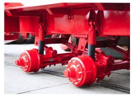
Train roulant avec suspension hydropneumatique.
