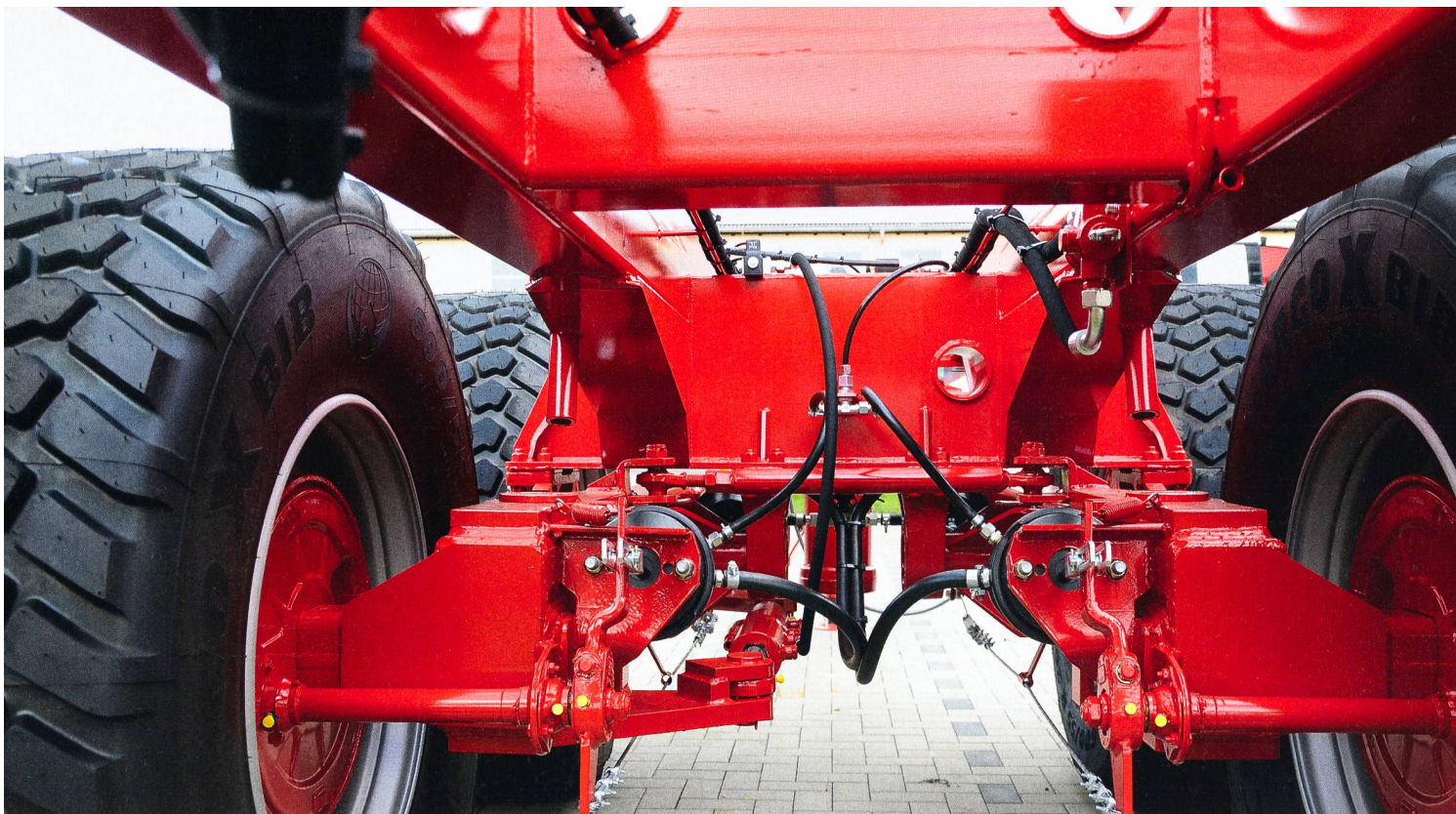
Train roulant oscillant avec essieu guidé et freins pneumatiques.
