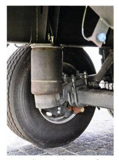
La suspension pneumatique entre en ligne de compte pour les grosses remorques de transport agricoles.
