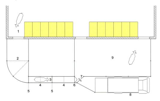
Fig. 8: Chargement avec dispositif de capture et de contention et aire d'attente dans l'étable (1), circuit de rabattage (2), couloir de contention (3) avec structure (4), portes coulissantes (5), porte de contention (6) et porte de tri (7) ainsi que véhicule de transport (8) et aire d'exercice extérieure (9).
