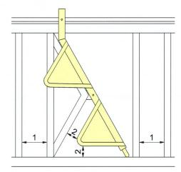
Fig. 6: Les cornadis autobloquants pour vaches-mères doivent respecter un intervalle de 11 bis 15 cm (1) entre les éléments fixes et de 7 cm max. (2) entre les éléments fixes et mobiles.
