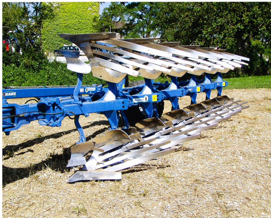
Dans les sols difficiles, la force de frottement est réduite en raison de la surface de contact moindre des versoirs ajourés.
