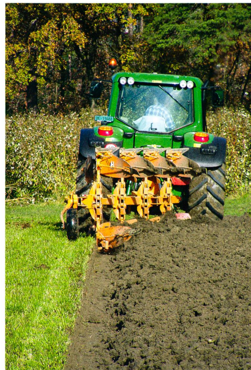
Une profondeur de travail inférieure permet de réduire notablement la consommation de carburant.
