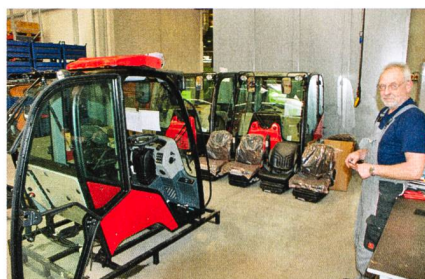
Des composants de grande qualité tels les cabines et les sièges prémontés, prêts pour l'assemblage.
