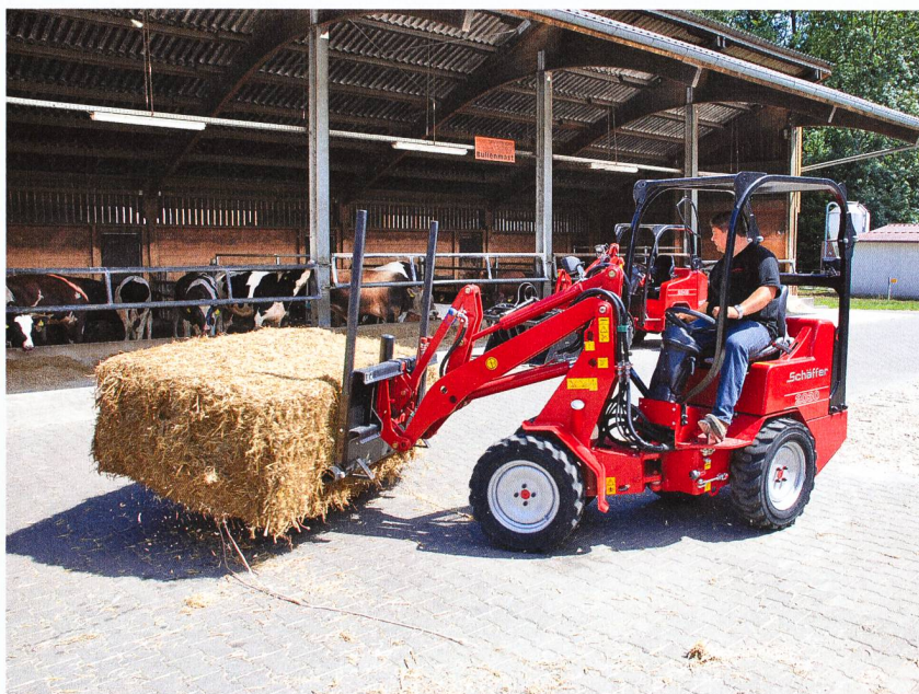
Le chargeur compact 2030 est très maniable grâce à son centre de gravité situé très bas.
