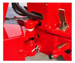
Les articulations, ici le 3345, proviennent de la maison Heyd dans le Bade-Wurtemberg. L'anneau conique et la carrosserie sont de fabrication maison. Schäffer a également développé le système de pince type conique, protégé par le modèle déposé.
