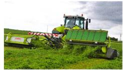
Le Disco 9100 Autoswather avec conditionneur à rouleaux propose toutes les possibilités d'andainage, jusqu'à l'épandage large à l'œuvre dans un magnifique champ de lucerne.
