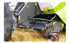
La nouvelle presse à balles rondes CLAAS Quadrant 3300 comble une lacune entre les modèles 3200 et 3400. Cette presse est équipée d'un système de préchambre commandé automatiquement et géré par le conducteur. Le convoyeur, le rotor et le pick-up sont interactifs.
