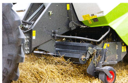
La nouvelle presse à balles rondes CLAAS Quadrant 3300 comble une lacune entre les modèles 3200 et 3400. Cette presse est équipée d'un système de préchambre commandé automatiquement et géré par le conducteur. Le convoyeur, le rotor et le pick-up sont interactifs.
