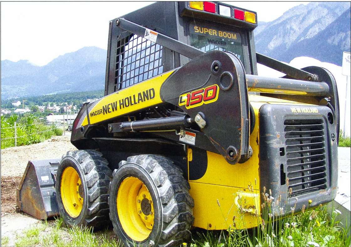
Sur les chargeurs compacts, l'utilisation de roues de petit diamètre abaisse fortement le centre de gravité.
