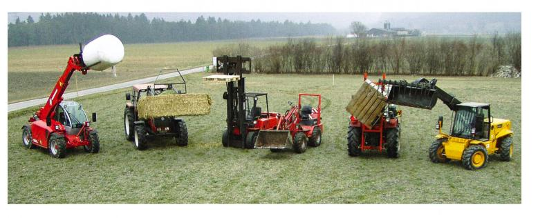
Il y dix ans, la situation était claire: il y avait le chargeur étroit, pour la ferme, le chargeur téléscopique et l'élévateur à fourche. Particulièrement maniable, ce dernier servait à manipuler et empiler palettes et paloxes sur des sols en dur. Au chargeur téléscopique revenait la tâche de transbahuter tout objet pesant, et le chargeur étroit, classiquement articulé, bon à tout faire, se faufilait partout, pour sortir le fumier, soulever une palette, décharger un paloxe.
