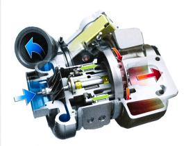
Les turbocompreseur à géometrie variable sont utilisés surtout dan les moteurs avec FGR.
