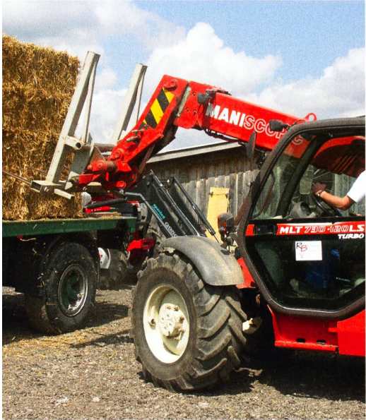
Comparé aux chargeurs frontaux, les chargeurs téléscopiques sont plus rapides et atteignent des hauteurs de levage plus élevées.
