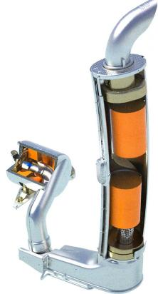
SCR de MF: Système SCR de deuxième génération de AGCO Sisu Power, tel qu'il se retrouve sur les séries 7600 et 8600 Massey Ferguson: combinaison d'un catalyseur à oxydation avec deux catalyseurs SCR fonctionnant en parallèle, mais disposés l'un derrière l'autre. Dans les derniers de ceux-ci, des catalyseurs slip sont encore intégrés et permettent la transformation des restes d'ammoniac en azote atmosphérique.
