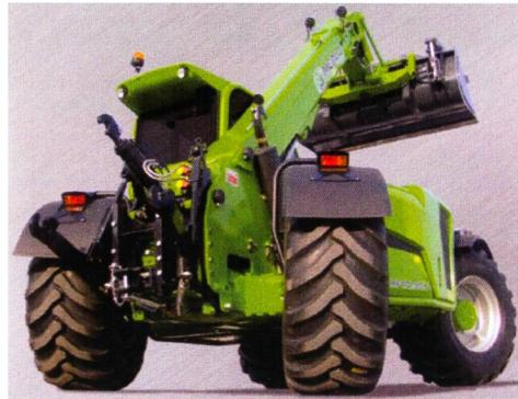
En plus du bras télescopique pour tous travaux de manutention à la ferme et dans les champs, le Multifarmer avec sa prise de force mécanique et son relevage 3 points, effectue également des travaux jusqu'ici réservés aux tracteurs. Pour le printemps 2012 Merlo
