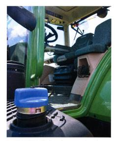
Le CONFORT s'écrit en lettres majuscules, également pour le siège passager qui sert de support pour écrire quand il est rabattu. Au premier plan se trouve l'orifice de remplissage de la solution d'urée AdBlue.
