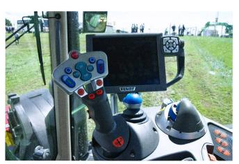
Les éléments les plus divers, tels que les fonctions du tracteur, la gestion ISOBUS, le guidage par trace et la compilation des opérations sont rassemblés sur un seul terminal.
