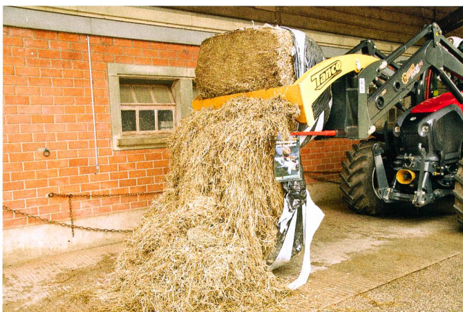
Le spécialiste de l'enrubannage Tanco propose une pince coupante, la 170 Bale Shear. Celle-ci saisit l'enrubannage extérieur tout en coupant la balle en deux. Elle permet la distribution directement dans les passages pour aliments ou dans les désileuses.
