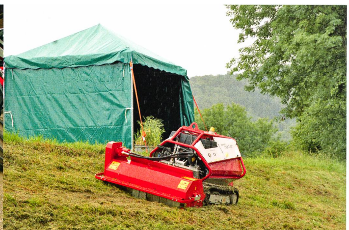
La Speedy Cutter télécommandée peut travailler sur des pentes jusqu'à 50°. L'opérateur peut se tenir jusqu'à une distance d'une centaine de mètres, le protégeant ainsi de tout incident qui pourrait survenir.
