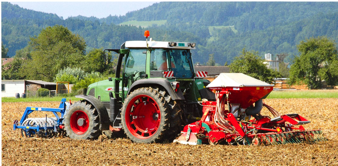
Semis de colza sur bandes fraîsées: lit de semences optimal et enfouissement de paille. (Photos: Thomas Anken)
