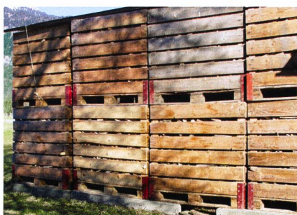
Exposé à l'air et au soleil, le bois abrité de la pluie sèche en l'espace d'une année.
