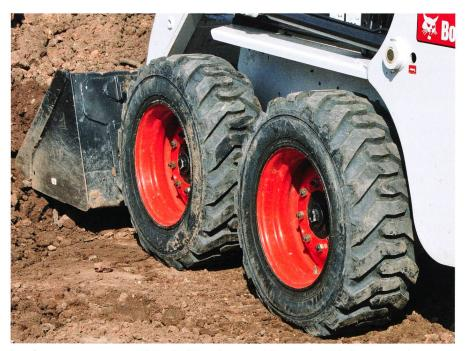
Les deux nouveaux pneus BibSteel All-Terrain et Hard-Terrain de Michelin propose la technologie radiale pour les chargeurs compacts (à direction par freinage ou articulation), ainsi que pour les chargeurs de divers types. Ces pneus sont prévus pour remplir différentes exigences sur route et dans le terrain. Les flancs renforcés de ces pneus contribuent à une meilleure stabilité du véhicule.
