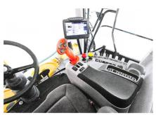
La console, avec son moniteur IntelliView III à écran tactile et son levier multifonctionnel CommandGrip, se retrouve à la fois sur les séries de moissonneuses-batteuses et sur les nouveaux tracteurs New Holland T7 et T8.
