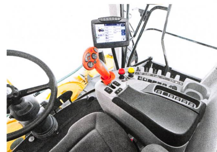
La console, avec son moniteur IntelliView III à écran tactile et son levier multifonctionnel CommandGrip, se retrouve à la fois sur les séries de moissonneuses-batteuses et sur les nouveaux tracteurs New Holland T7 et T8.
