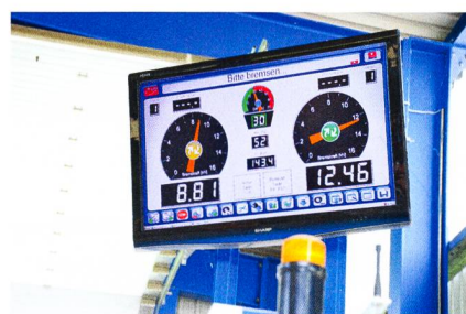
L'affichage analogue et numérique montre une différence de freinage considérable entre la roue gauche et la route droite. Après le test, un procès-verbal de freinage est établi comme la loi l'exige pour les remorques roulant à 40 km/h.
