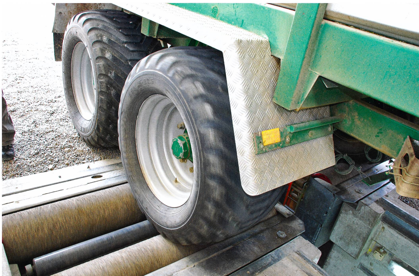
Les performances des essieux, placés les uns après les autres sur le banc de contrôle sont mesurées sur différents niveaux de chargement.
