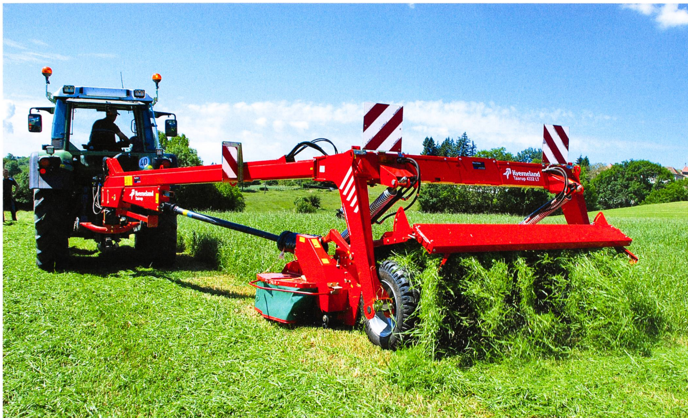
La faucheuse-faneuse articulée Kverneland Taarup 4332 LT, à 8 disques, avec une largeur de travail de 3,20 m. Sur cette conditionneuse à dents métalliques SemiSwing, les dents se replient vers l'arrière et franchissent des obstacles de 103 mm sans se briser. (Photos: Dominik Senn)
