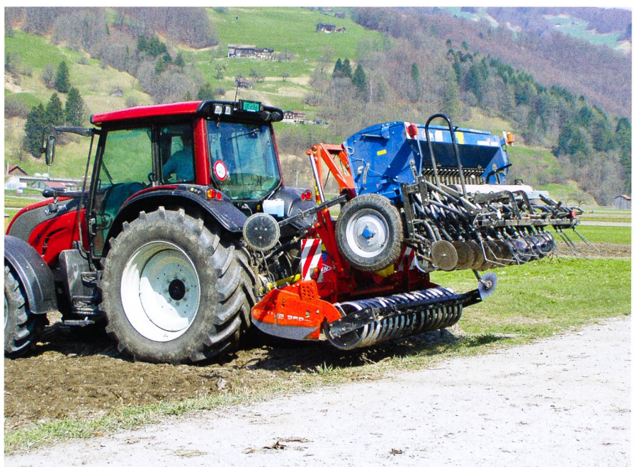
Les combinaisons de semis peuvent être utilisées après déchaumage pour le semis de la culture suivante.
