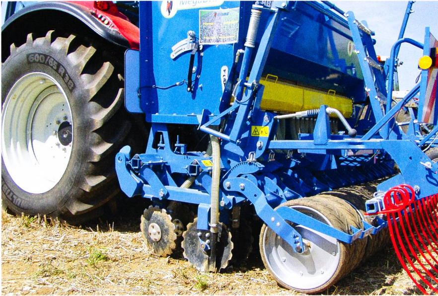
Herse à disque compacte avec semoir porté: le déchaumage classique est ici en grande partie inexistant.
