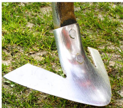
Les socs patte d'oie sont bien adaptés, surtout pour le déchaumage en superficie. Ils sont cependant soumis à une forte usure.
