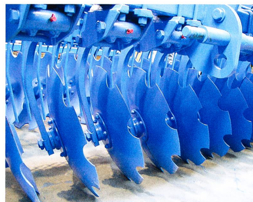
Une attaque correcte et des disques fortement crénelés assurent une agressivité élevée.
