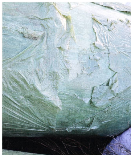
Lorsque la protection contre les UV est insuffisante ou diminue progressivement, des signes d'affaiblissement du film apparaissent.
