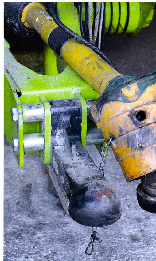
Les dispositifs d'attelage à boule réduisent considérablement l'usure avec les presses à balles cubiques.
