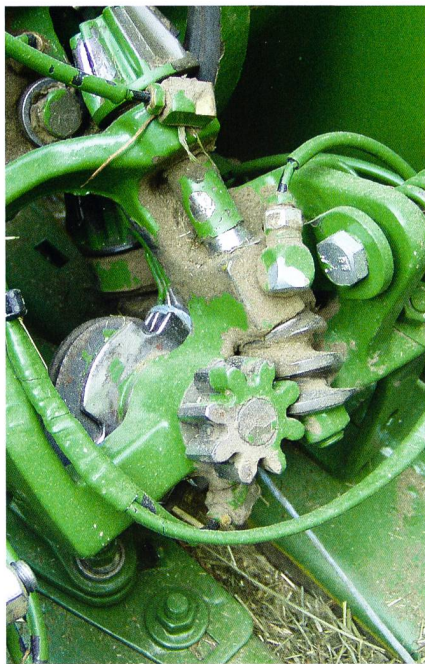
Système de nouage simple Deering tel qu'il est disponible sur les presses haute densité John Deere.
