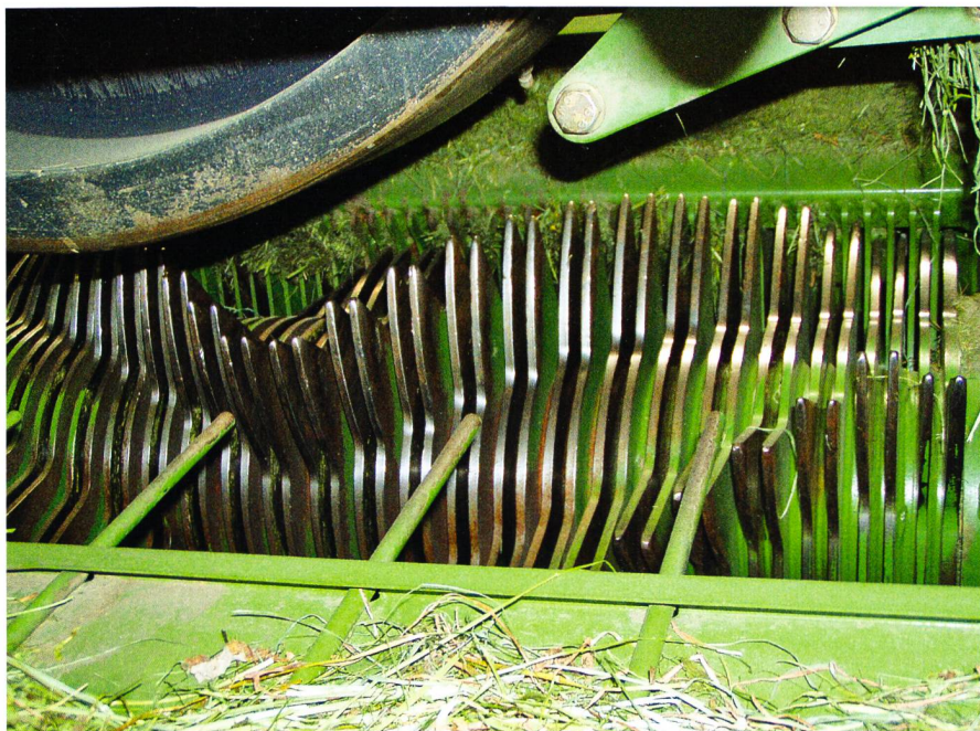
Les rotors de coupe entraînent la matière à presser de manière régulière dans le canal de précompression.
