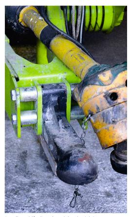
Les dispositifs d'attelage à boule réduisent considérablement l'usure ave les presses à balles cubiques.
