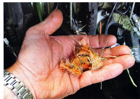
Caractéristique du noueur Deering : le petit reste de ficelle sur la balle.
