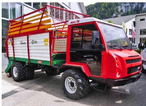
Autochargeuse Lüönd adaptable pour tous les transporteurs.
