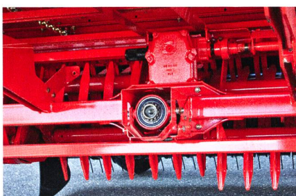
Système d'accouplement rapide: l'outil de travail se monte et se dépose sans outil ni arbre de transmission.
