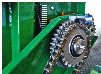
Graissage automatique de l'entraînement à chaîne avec un distributeur d'huile.
