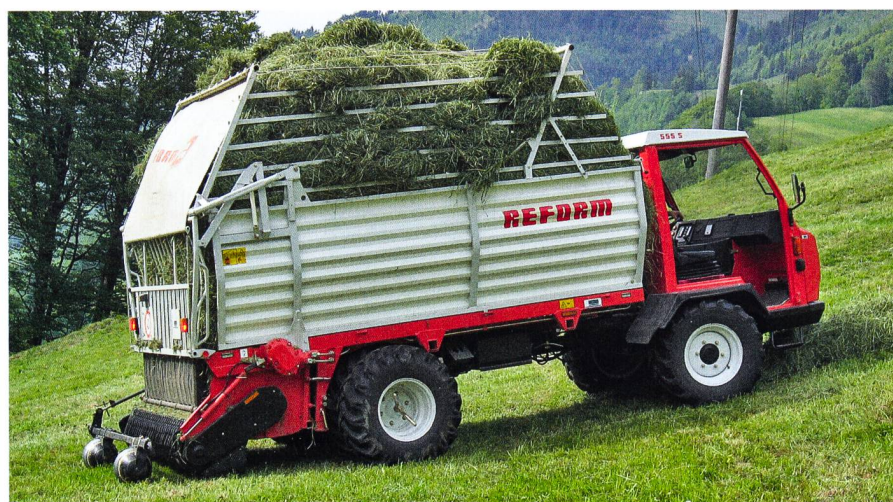
Adaptation parfaite au terrain grâce au guidage en parallèle des roues de jauge. Leur réglage en hauteur se fait sans outil.
