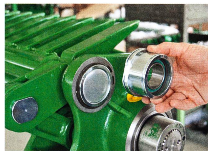
Bague de fixation sans entretien du pick-up de l'autochargeuse Lüönd.
