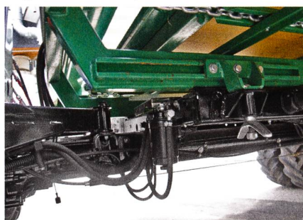
Les autochargeuses portées Lüönd s'adaptent à tous les modèles de transporteurs grâce à des éléments de montage vissés.
