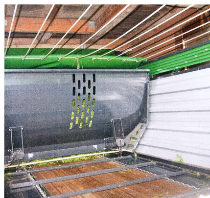
Exécution spéciale de l'autochargeuse Schiltrac: paroi mobile sur fond mouvant assurant une vidange rapide et complète.
